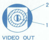
デジタルテロップ用端子配置図 (本体後面側から見た図)
